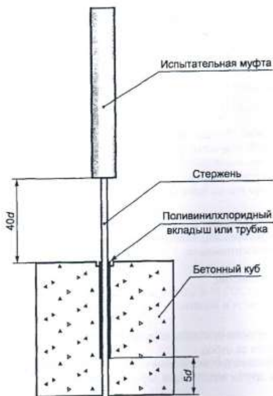
Рисунок Д.1 — Схема установки АКП в бетон куба
